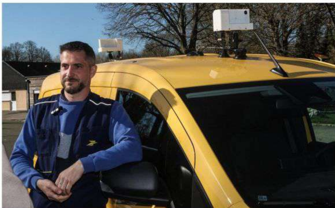
Facteur à Ailly-sur-Noye, Kevin Bauer fait désormais sa tournée avec deux caméras installées sur le toit de son véhicule. Objectif, cartographier et diagnostiquer l'état de la chaussée. Photo Kevin Devigne
