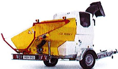
MOTEUR DE 1498 cm<sup>3</sup>, 4 cyl, 25 ch DIESEL
