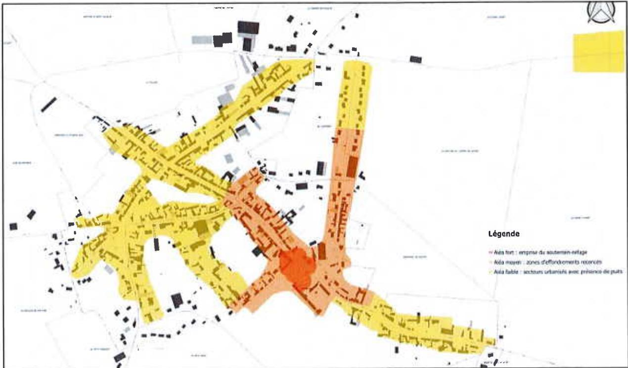
Sur les secteurs dont l'aléa est moyen à fort, VERDI propose le mode opératoire suivant : terrassement à l'aide d'un camion aspirateur excavateur, remblai avec un matériau de type gravette, matériau autoplaçant ne nécessitant pas de matériel vibrant pour le compactage.
